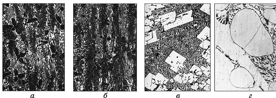
Рис. 2. Мікроструктура сплавів Fe–B–C, охолоджених зі швидкістю у 10^3 К/с ( \times 1000 ): зразок 2 (а), зразок 3 (б), зразок 5 (в), зразок 6 (з).
